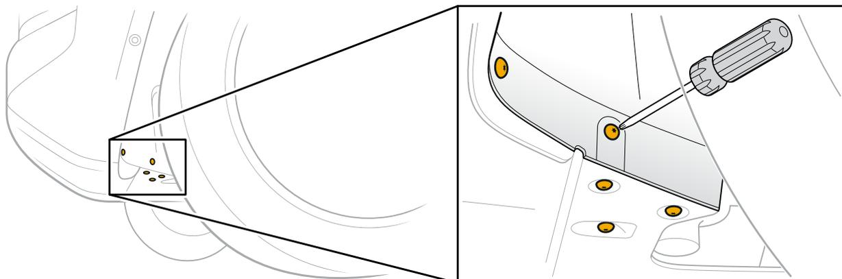
2. Abaissez la plaque de protection avant pour accéder au câble d'ouverture du capot.
