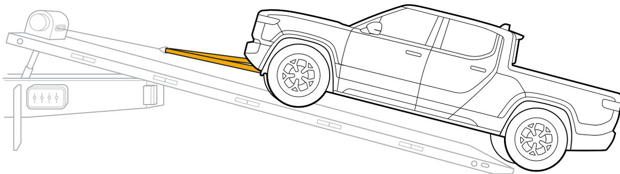
5. Amarrez le véhicule à l'aide de sangles de retenue à huit points, avec deux points de contact par coin.
