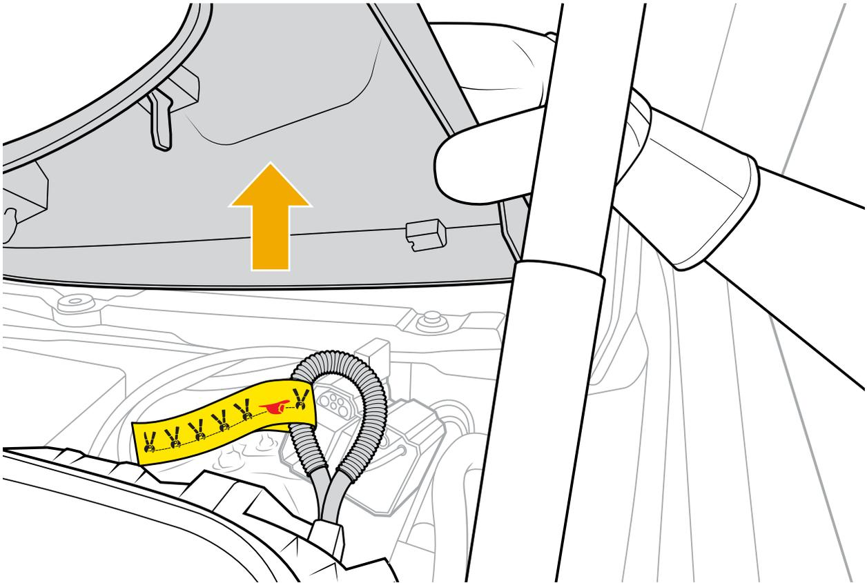
4. Trouvez la boucle du câble électrique avec l'étiquette de coupe jaune. Coupez la boucle à une extrémité (1) et à l'autre extrémité (2).
