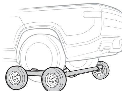
4. Lorsque les roues arrière sont décollées du sol, placez le véhicule pour le charger sur la caisse de la dépanneuse.
