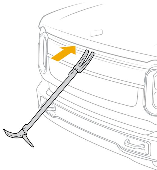
2. Insérez le écarteur hydraulique et brisez le loquet du capot.
