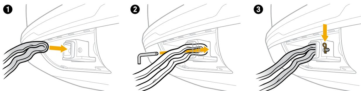
5. Insérez la broche de remorquage à travers le dispositif d'attelage afin de connecter la bride ou les œillets (2), puis installez l'attache de retenue de la broche de remorquage (3).
